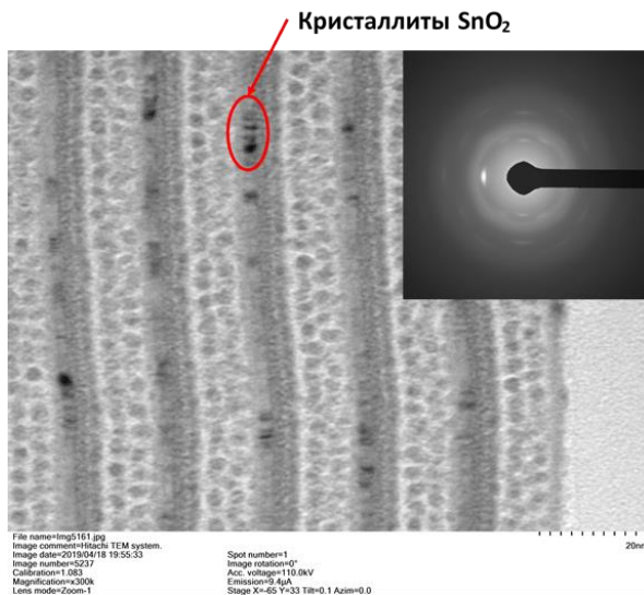
Рис. 1 Электронограмма и участок поперечного среза многослойной структуры [(\text{Co}_{40}\text{Fe}_{40}\text{B}_{20})_{34}(\text{SiO}_2)_{66}/\text{ZnO}/\text{SnO}_2]_{33}
